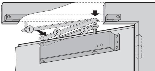
④B Pivoter le levier (3) un tour en arrière (4) (précontraint). Engager entièrement le levier dans le ferme-porte (5) et serrer la vis de blocage (5a).
