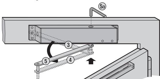
⑤A Tourner le levier (5) en direction du rail jusqu'au galet de plastique (6) et encastrer dans celui-ci (6a).
