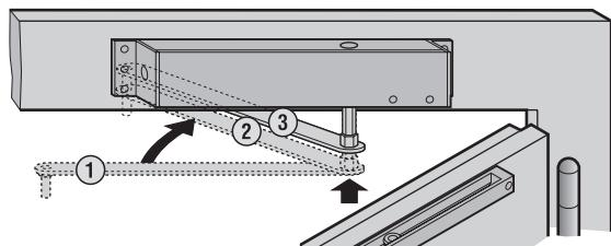
④A Pivoter le levier (3) un tour en arrière (4) (précontraint). Engager entièrement le levier dans le ferme-porte (5) et serrer la vis de blocage (5a).
