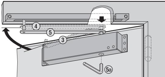
⑤B Tourner le levier (5) en direction du rail jusqu'au galet de plastique (6) et encastrer dans celui-ci (6a).
