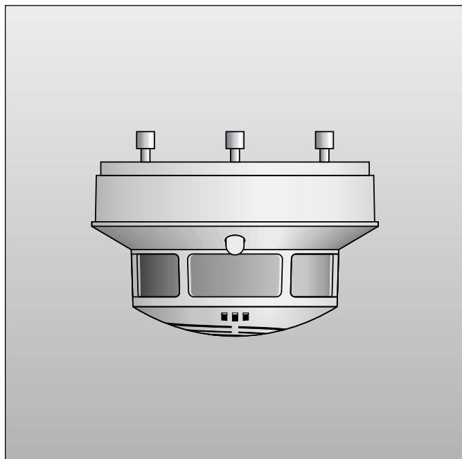
Der optische Rauchschalter ORS 142 erkennt frühzeitig sowohl Schwellbrände als auch offene Brände mit Rauchentwicklung. Ein zusätzlicher Temperaturfühler spricht bei einer Umgebungstemperatur von 70 °C an. In Bereichen mit Störgrößen wie Dampf, Staub, Betauung und betriebsbedingter Rauchentwicklung empfehlen wir den Einsatz unseres Thermodifferentialschalters TDS 247. Es sind die länderspezifischen Vorschriften zu beachten.
